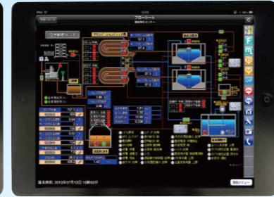
フローシート (下水処理施設)
