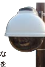
監視用カメラ (屋外用)
