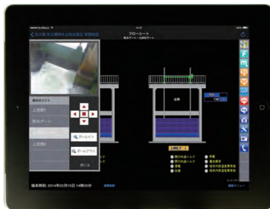
カメラ映像・開度・警報表示 (タブレット端末)
