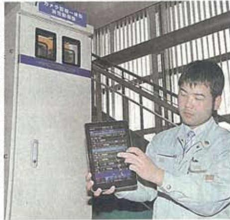
小松電機産業が運用を始めた、遠隔地から「消融雪装置」の操作ができるタブレット端末。松江市乃木福富町、同社
